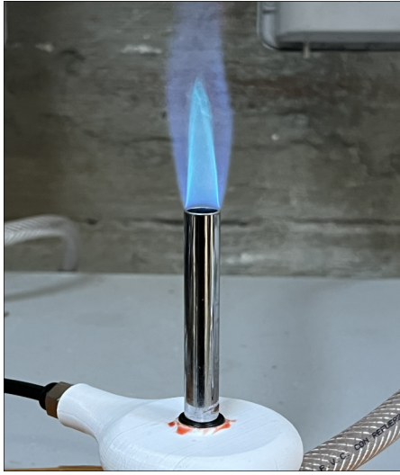
((a)) Imagen del mechero Bunsen con adaptación para dosificar ingreso de aire primario.
