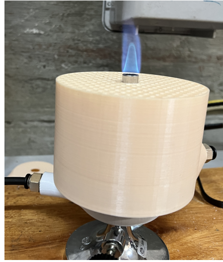
((b)) Mechero con direccionador de aire secundario y dosificador de aire primario.
