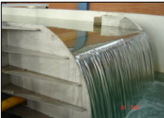
Figura 3.3.- Compuerta batiente al final del canal
