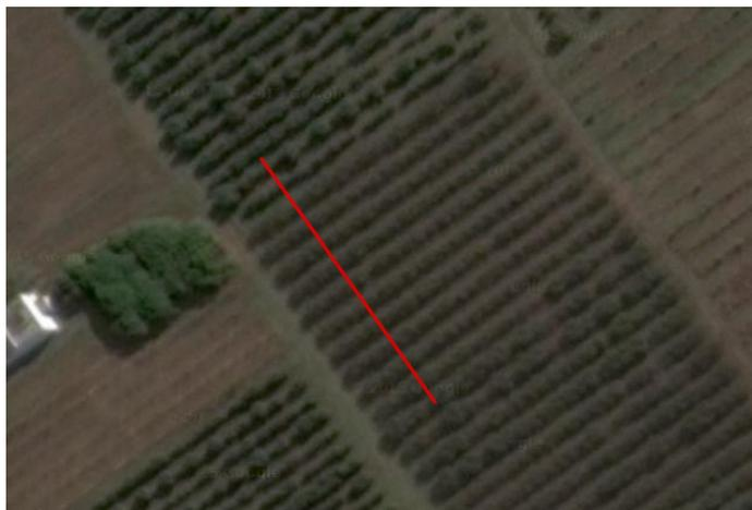
Figura 6.5: Disposición de nodos *WimSN* entre surcos. Los nodos se ubican en los extremos de la línea roja de la imagen.
