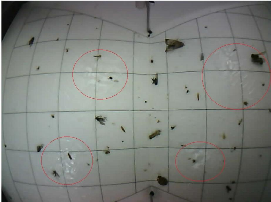
Figura 3.2: Imagen 081 del banco, muestra señalado con rojo los brillos indeseados.
