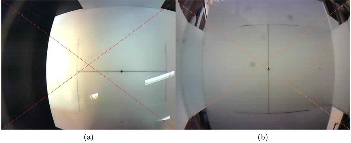
Figura B.2: (a) Fotografía tomada con la cámara centrada, y soporte por defecto. (b) Fotografía tomada con la cámara centrada, y soporte centrado.
