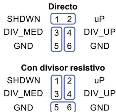
Figura 2.15: Diagrama de conexión de jumpers
