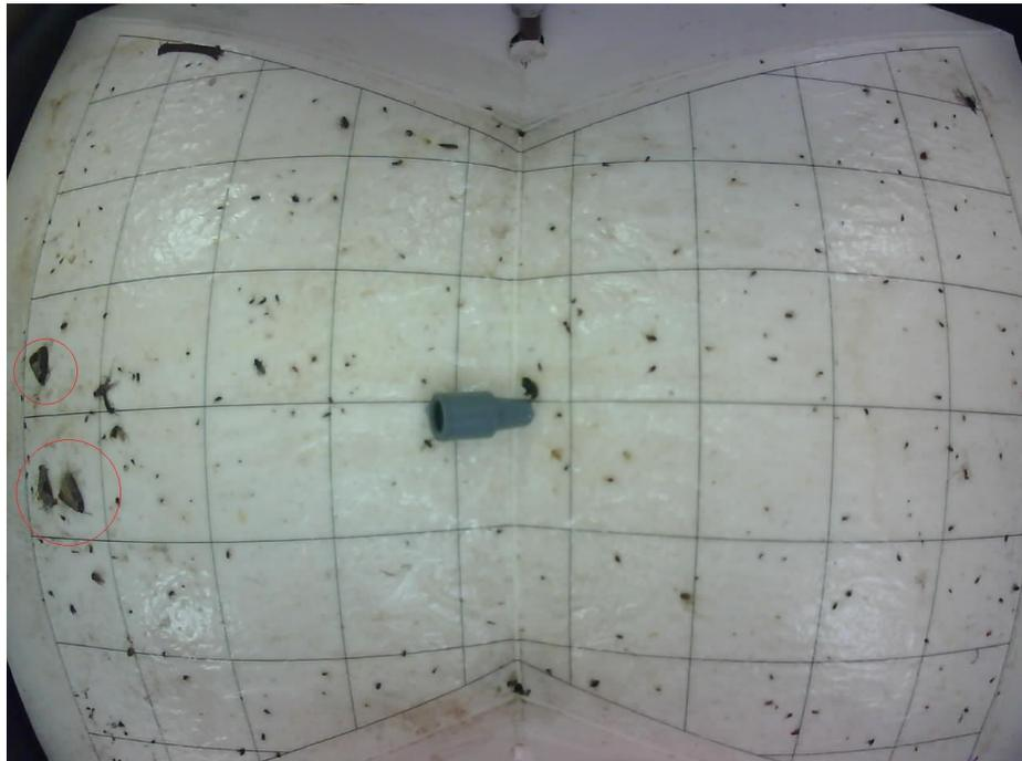
Figura 3.7: Imagen 130 del banco de imágenes; Piso inclinado (inclinación por defecto); 4 LEDs blancos en esquinas del techo de la trampa, dirigidos hacia arriba;  $H=12,5$  cm; lente HX-1820; Tamaño 80 kB
