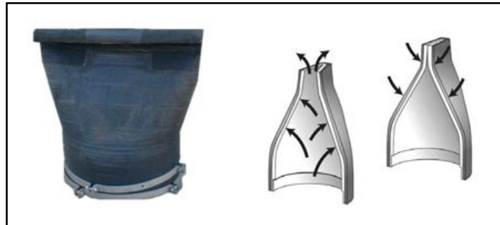
Figura 49: Válvula de descarga anti retorno tipo “pico de pato”
