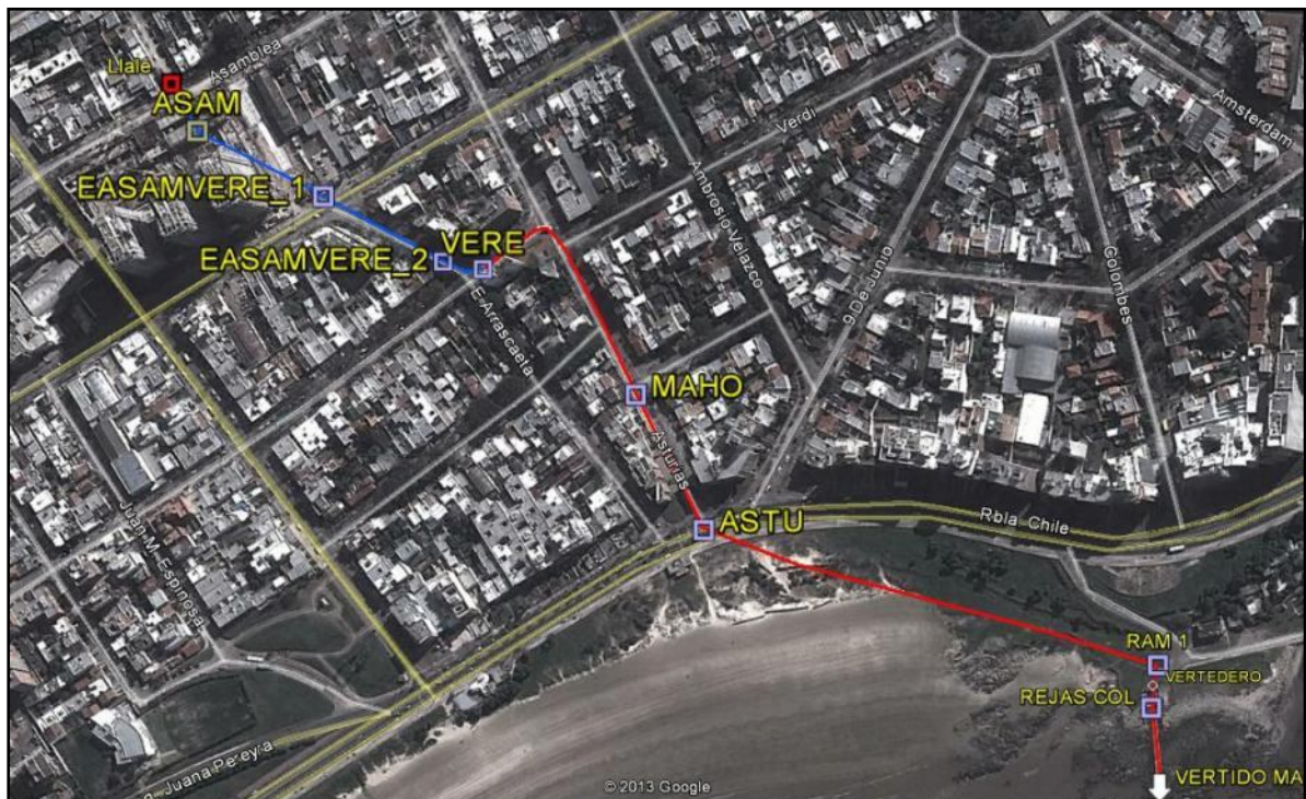
Figura 8: Esquema del modelo del colector principal
