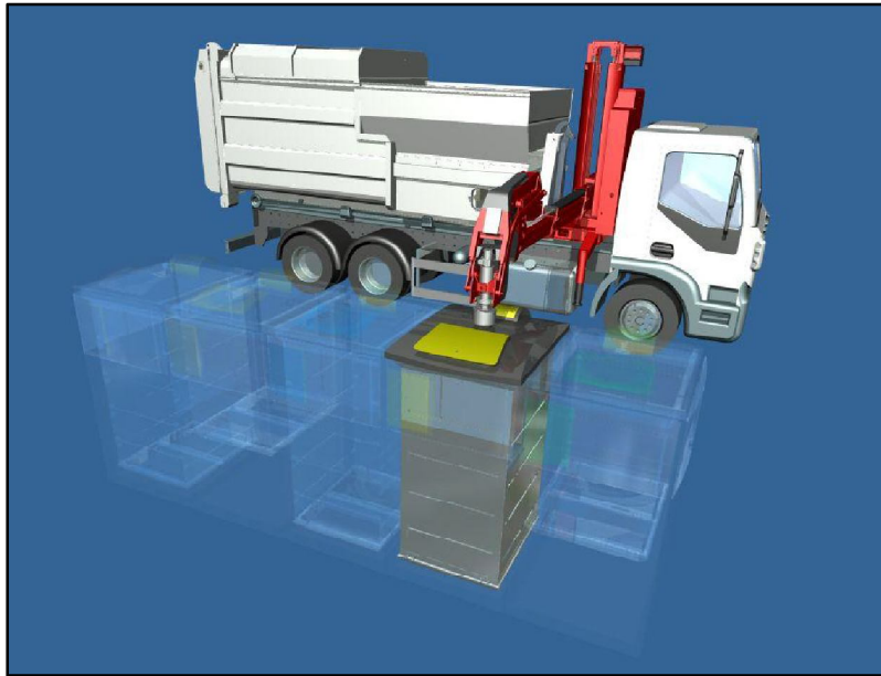
Figura 20: Extracción de un contenedor semi enterrado
