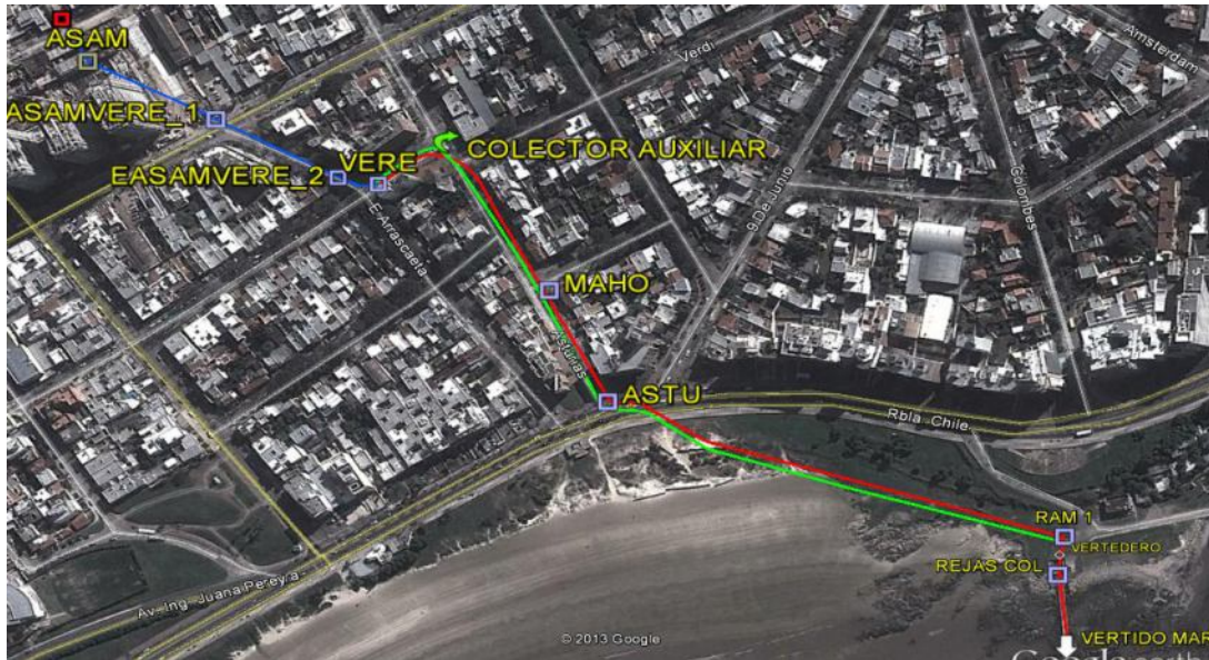
Figura 29: Esquema Colector de traza paralela en verde, colector existente en rojo
