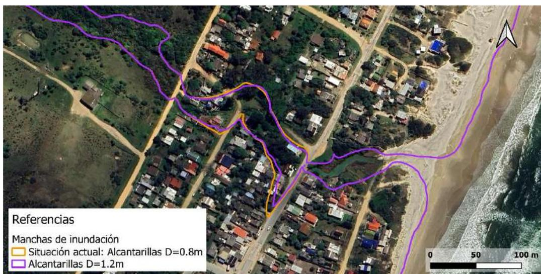
Figura 5-9. Manchas de inundación para situación actual y rediseño de alcantarillas – Tipo Z
