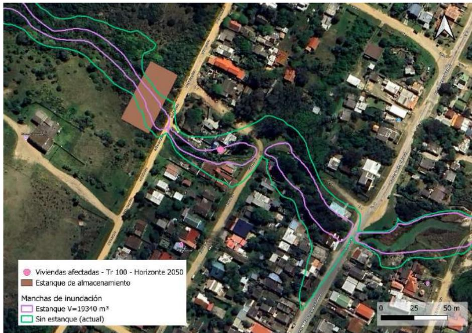
Figura 5-12. Manchas de inundación con y sin presencia de estanque de almacenamiento - Tr100, horizonte 2050
