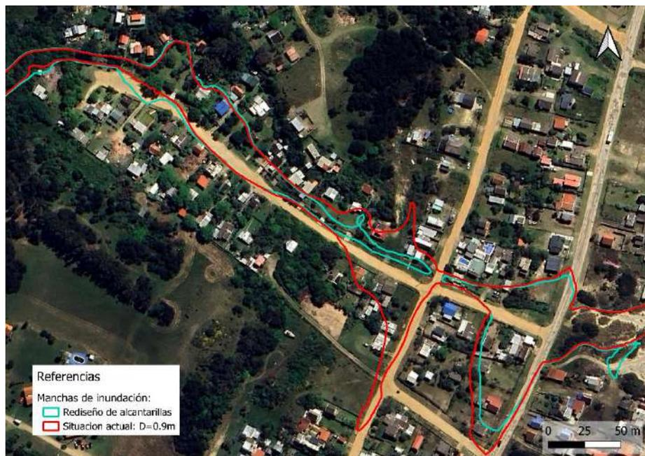
Figura 5-13. Manchas de inundación con alcantarillas actuales y rediseño - Tr100 años, horizonte 2050
