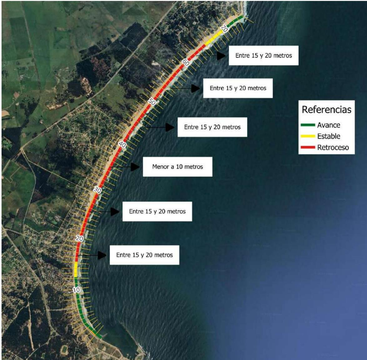
Figura 10-4 - Retroceso de la línea de costa mediana anual proyectada por segmento. Horizonte 2050.
