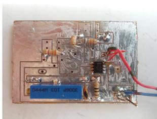
Figura 2.10: Circuito amplificador.
