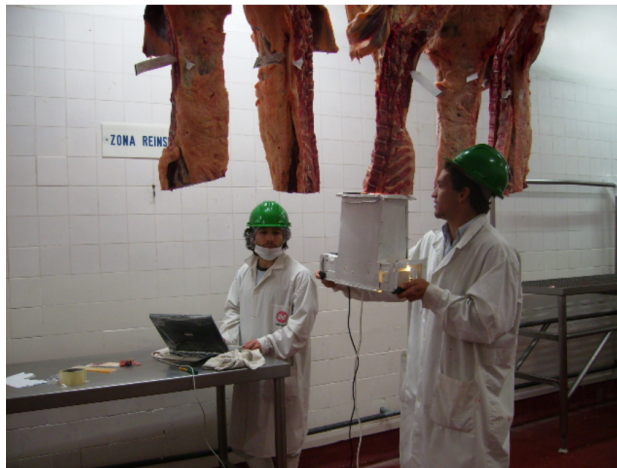
Figura 6.1: Operación hardware adquisidor de imágenes color. Imagen obtenida del proyecto “Ojo de Bife”.
