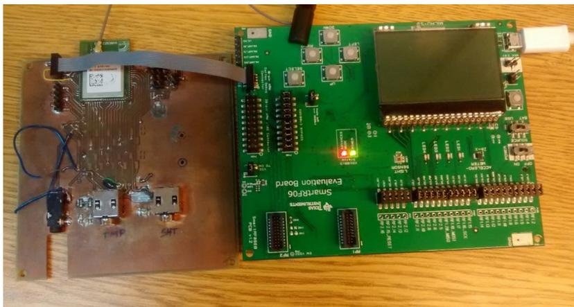
Figura B.9: Conexión placa RSItrust - SmartRF06.
