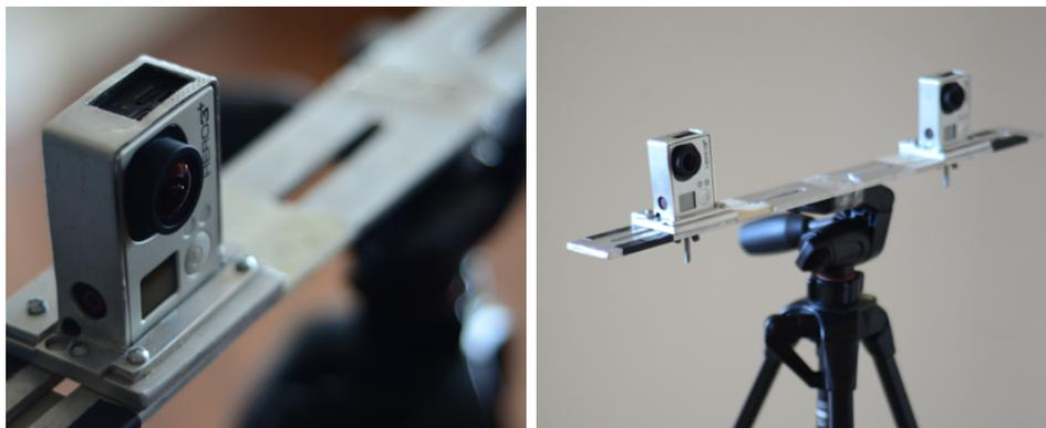
Figura E.1: Soporte utilizado para la configuración estéreo de las cámaras.
