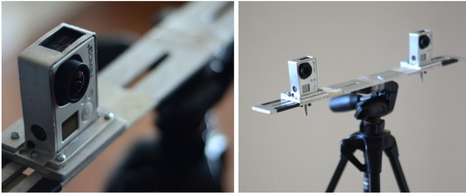
Figura 2.1: Soporte utilizado para la configuración estéreo de las cámaras.
