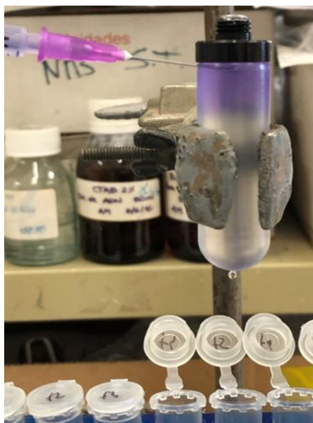
FIGURA 18. Fraccionamiento del gradiente de CsCl mediante bombeo de agua coloreada.
