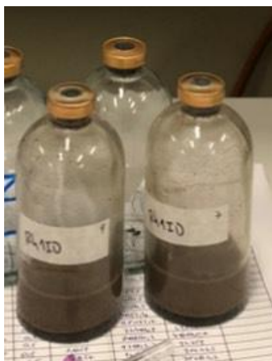
FIGURA 6. Microcosmos utilizados para la determinación de la actividad de oxidación de metano potencial.
