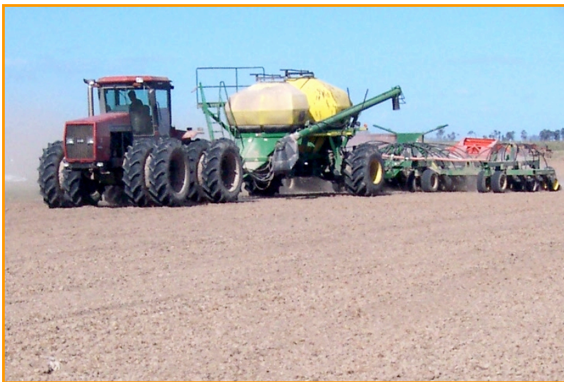
Sembradora de 10 mts de anchura-64 líneas
