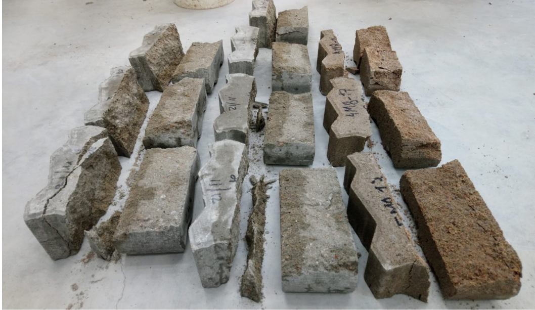
Figura 3.9: Adoquines luego de su rotura.
