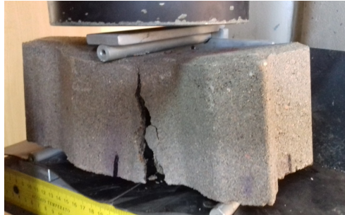
(a) Adoquín en rotura a tracción por flexión.
