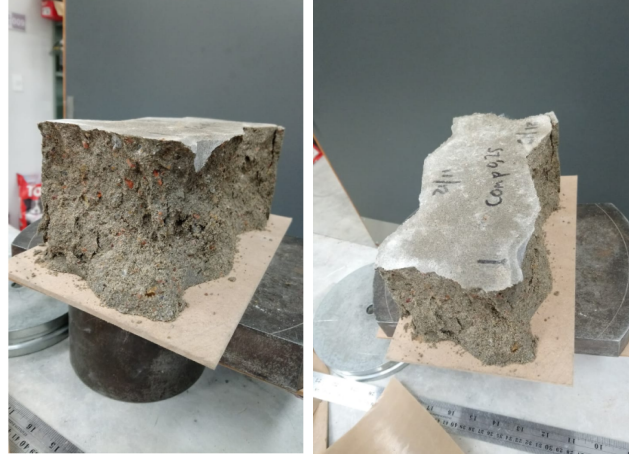
(a) Vista 1 del adoquín (b) Vista 2 del adoquín luego de su rotura.
