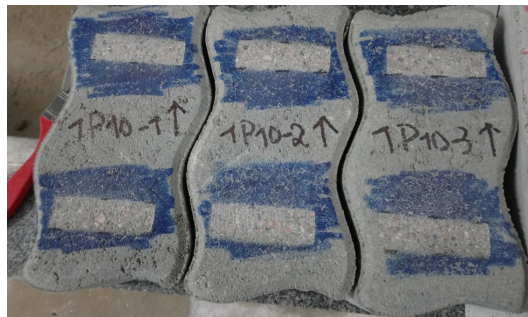
Figura 3.12: Adoquines posterior al ensayo de desgaste.
