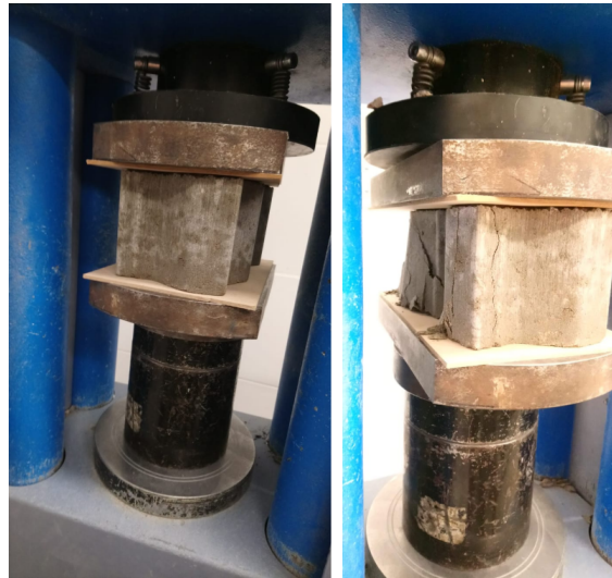
(a) Adoquín en proceso de carga. (b) Adoquín luego de su rotura.
