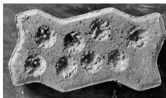
(a) Desgaste en adoquines [91].
