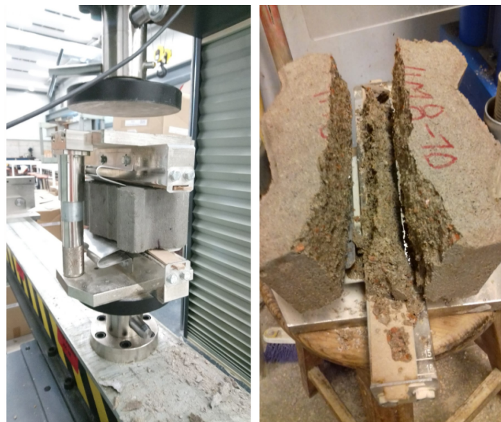
(a) Adoquín posicionado previo al ensayo.
