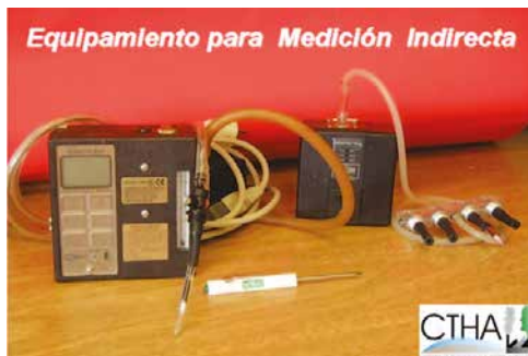
Figura 15. Bombas de aspiración
