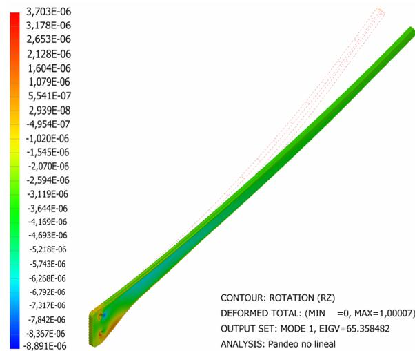
**Figura 4.18:** Resultado del análisis de pandeo realizado al nervio.
