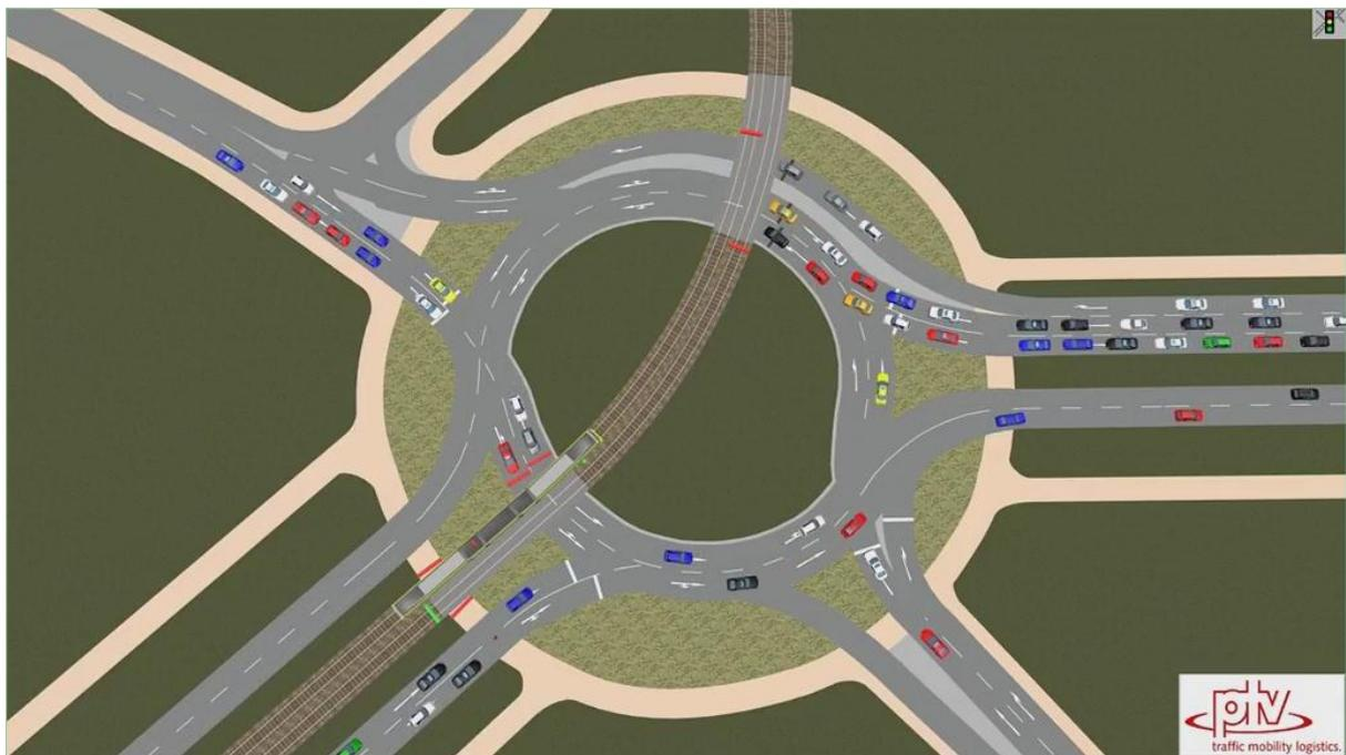
Figura 100: VisSim – Simulación de esquema de prioridades en una rotonda
