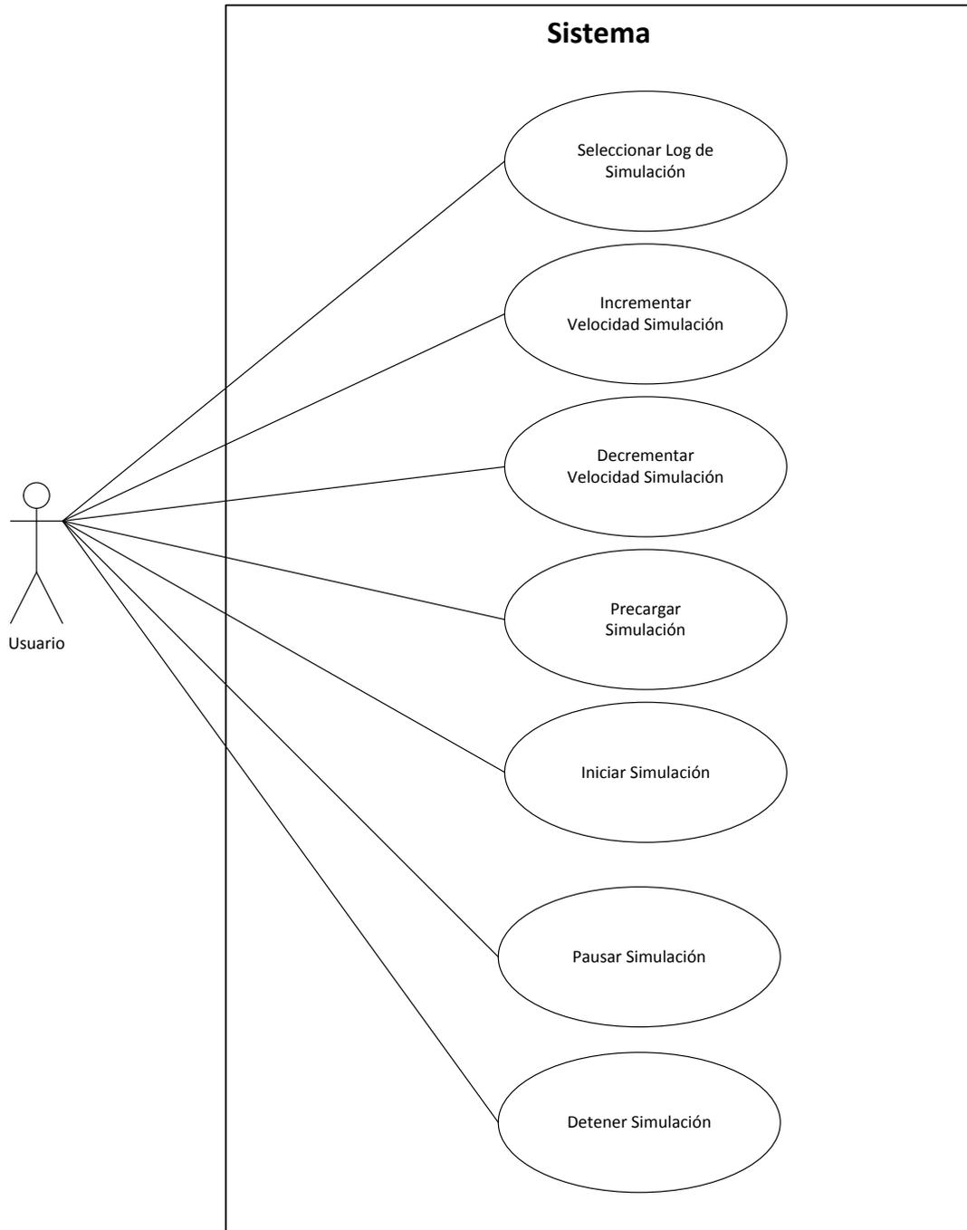
Figura 61: Requerimientos funcionales relativos al control de simulación
