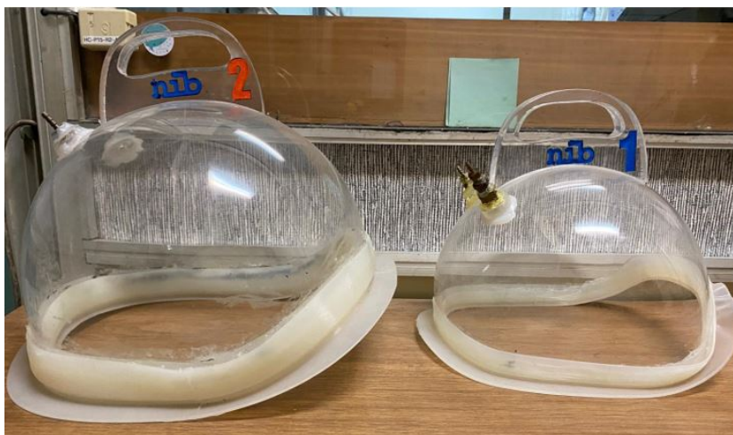
Figura 2.7: Campanas de ABDOPRE. La 1 (a la izquierda) tiene un volumen de 20 litros y la 2 (a la derecha) de 14 litros.
