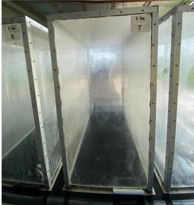
*Figura 7. Cámara de acumulación portátil identificadas con números para facilitar la medición*
