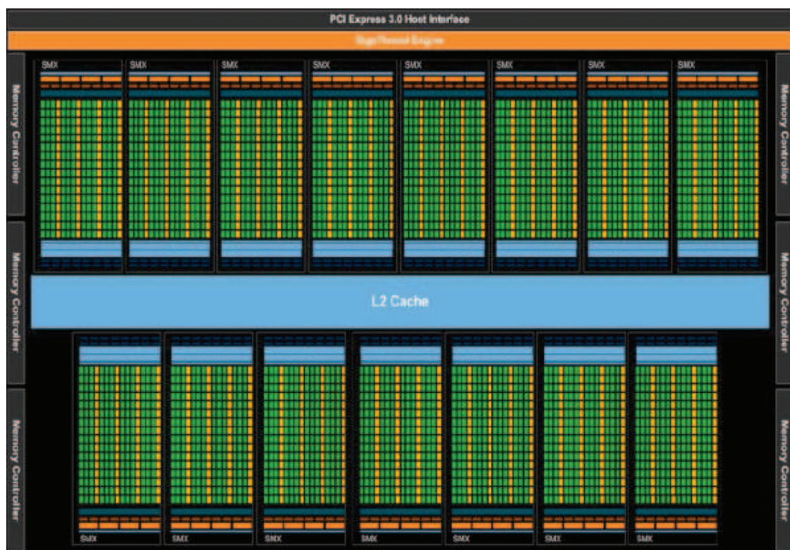
Figura A.3: Diagrama de bloques de la arquitectura Kepler GK110. Extraído de NVIDIA Kepler GK110 Architecture Whitepaper .
