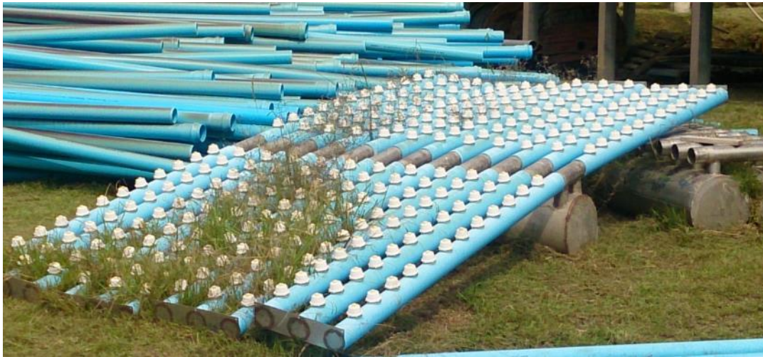
Figura 2.18. Nuevo falso fondo diseñado, pronto para su colocación.
