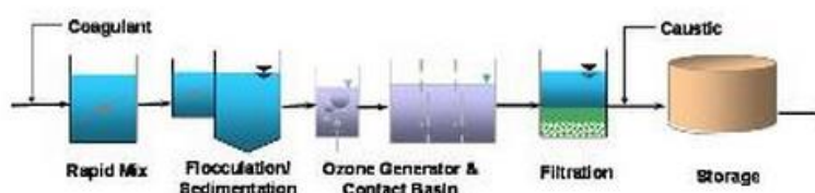
Figura 12.15. Ozono aplicado como inter-oxidante. Fuente: EPA
