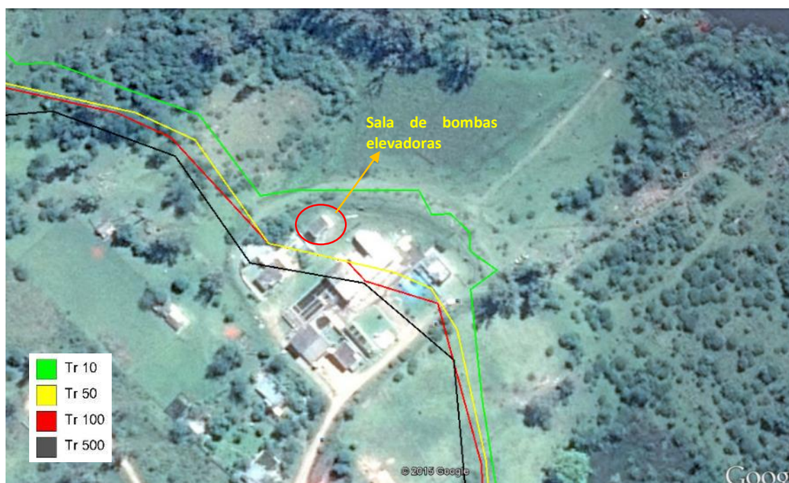
Figura 11.9 Curvas de inundación en la zona de la Planta Potabilizadora
