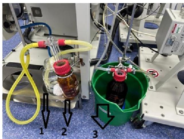
Figura 7: Trampas de hexano conectadas en las salidas de CO<sub>2</sub>. 1-Salida de CO<sub>2</sub> en la recolección del extracto, 2-recolección de extracto, 3-Salida de CO<sub>2</sub> al ambiente.
