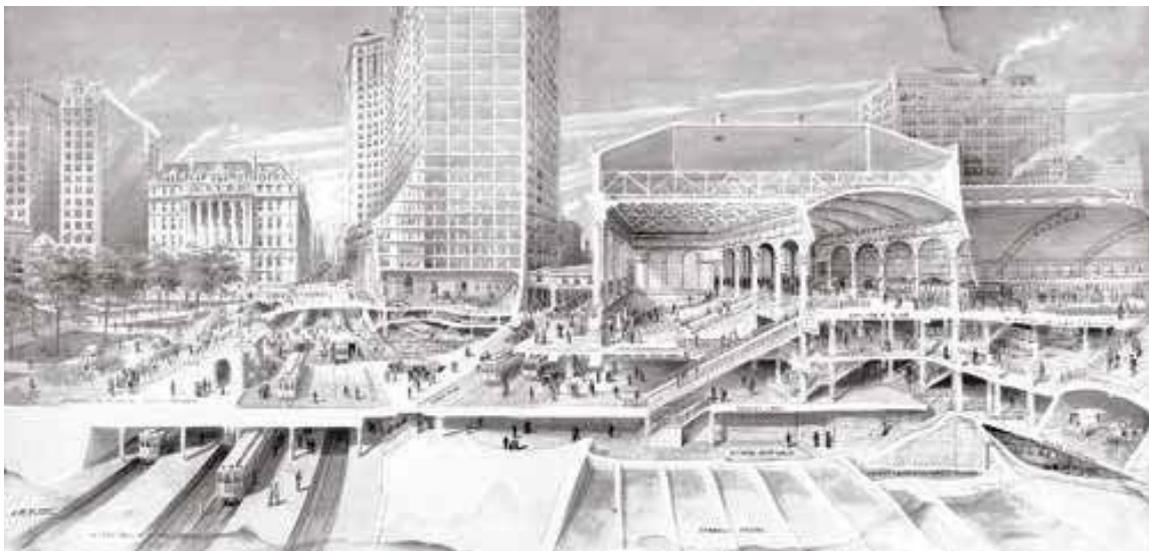
Fig. 5.16 Propuesta para una ampliación de la terminal en *Park Row* dibujada por Harry M. Pettit (1912 circa). El corte muestra los vínculos entre las plataformas de los trenes con los trolleys y el subterráneo. El *Municipal Building* aparece cortado en sección y está incorporado al sistema de intercambios a través de *Chambers Station*.
