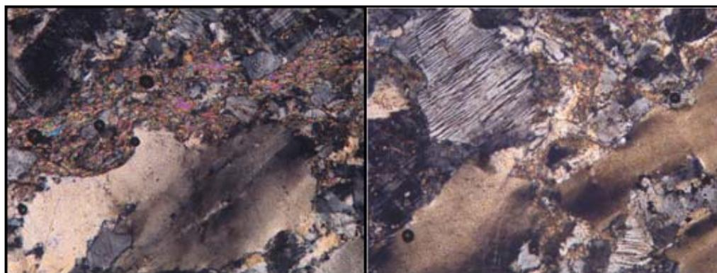
**Figura V.43:** A la izquierda cuarzo con extinción ondulante y evidencias de grain boundary migration. Matriz sericítica. Granos de feldespato alcalino. A la derecha cuarzo con extinción ondulante y evidencias de grain boundary migration. Feldespato alcalino mesopertítico. Polarizadores cruzados. Ancho de las imágenes = 1.8 mm.
