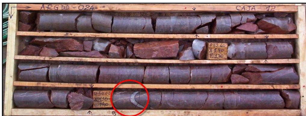
**Figura V.42:** Testigo de roca félsica deformada indiferenciada.
