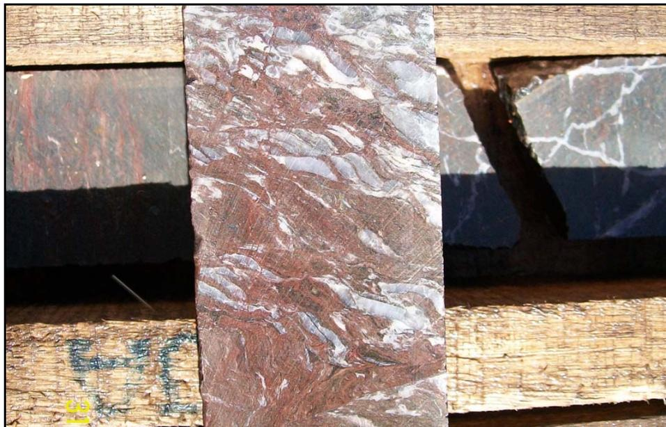
**Figura VIII.4:** Distribución de lentes de cuarzo en sondaje realizado en la Zona de Cizalla Zapucay (Cantera Knob Hill).
