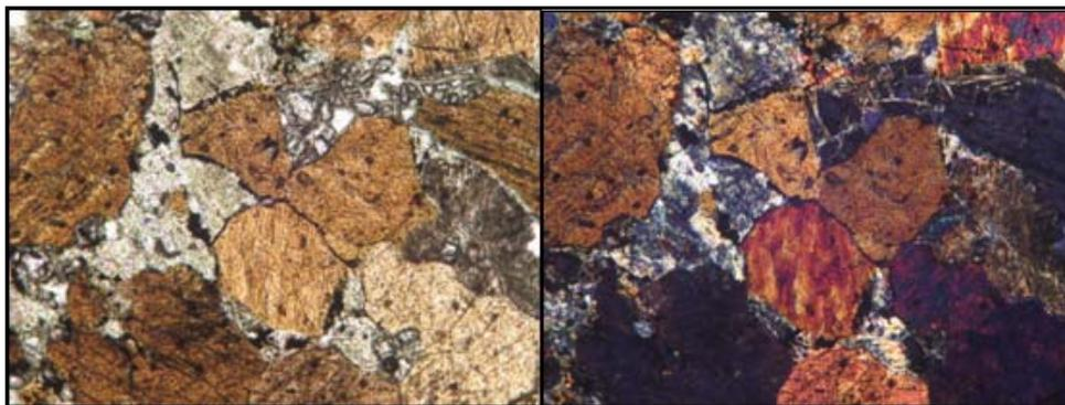
**Figura V.49:** Anfíbol pardo y feldespato alterado. Izquierda luz polarizada plana, derecha polarizadores cruzados. Ancho de las imágenes = 1.8 mm.
