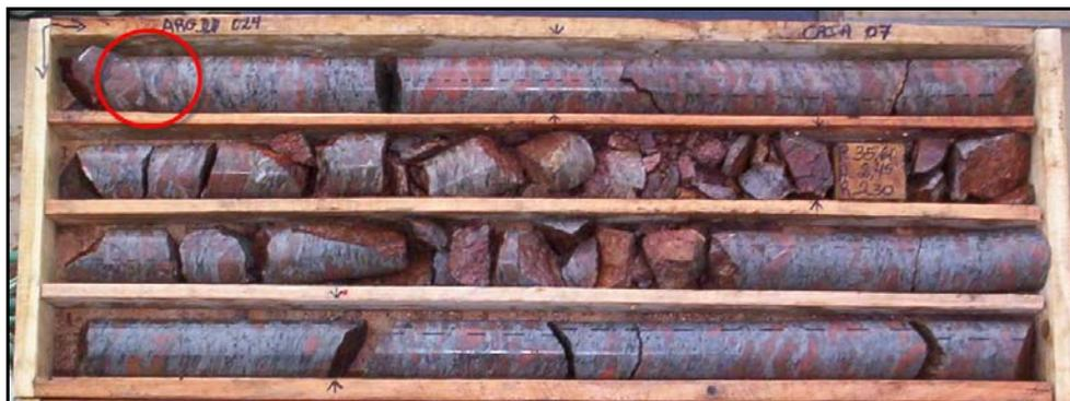
Figura V.36: Testigo de perforación de augen gneis.
