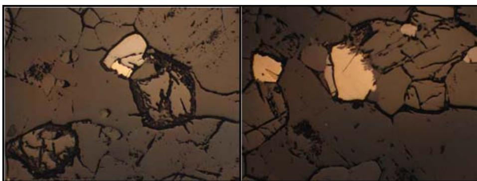
**Figura V.50:** Izquierda ilmenita y pirrotina. Derecha detalle de pirrotina con *flames* de pentlandita. En el extremo izquierdo del cristal de pirrotina inclusión de calcopirita. Luz polarizada plana reflejada. Ancho de las imágenes = 1.2 mm.
