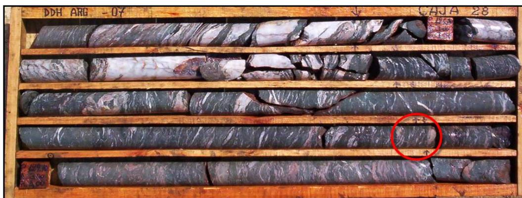
**Figura V.58:** Máfica deformada indiferenciada en muestra de mano.
