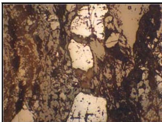
**Figura V.38:** Cristales euhedrales de magnetita. Luz polarizada plana reflejada. Ancho de la imagen = 1.2 mm.
