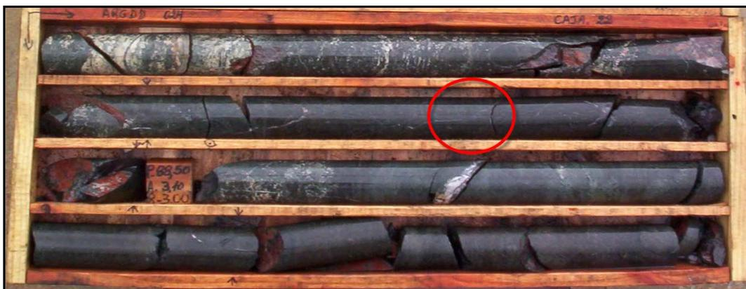
**Figura V.48:** Testigo de piroxenita.
