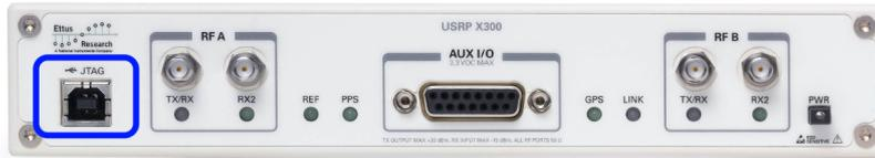
Figura D.1: Vista frontal del Ettus X300, con el puerto JTAG destacado en azul
