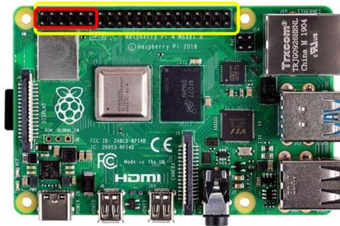
Figura C.2: Raspberry Pi 4, con los pines de conexión destacados en amarillo, y la sección más dañada de estos destacada en rojo.
