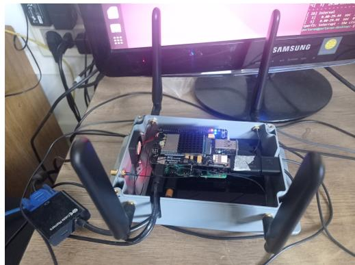
Figura C.1: Kit Sixfab 5G usado en el laboratorio, ensamblado en una Raspberry Pi 4.
