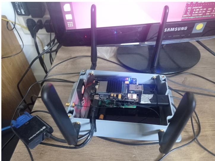
Figura 3.14: Kit de desarrollo *Sixfab 5G*, instalado en *Raspberry Pi 4*.
