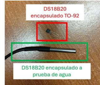
Figura 2.4: Sensor de temperatura DS18B20 junto a su versión con encapsulado a prueba de agua.
