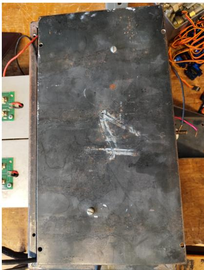
Figura 5.20: Contenedor completamente cerrado, simulando la situación de máxima atenuación
