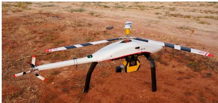
*Imagen 4: Ejemplo de Pulse Aerospace Vapor 55, Sky Heli. Fuente: YellowScan. (s.f.). Choosing the perfect drone for LiDAR mapping.*
