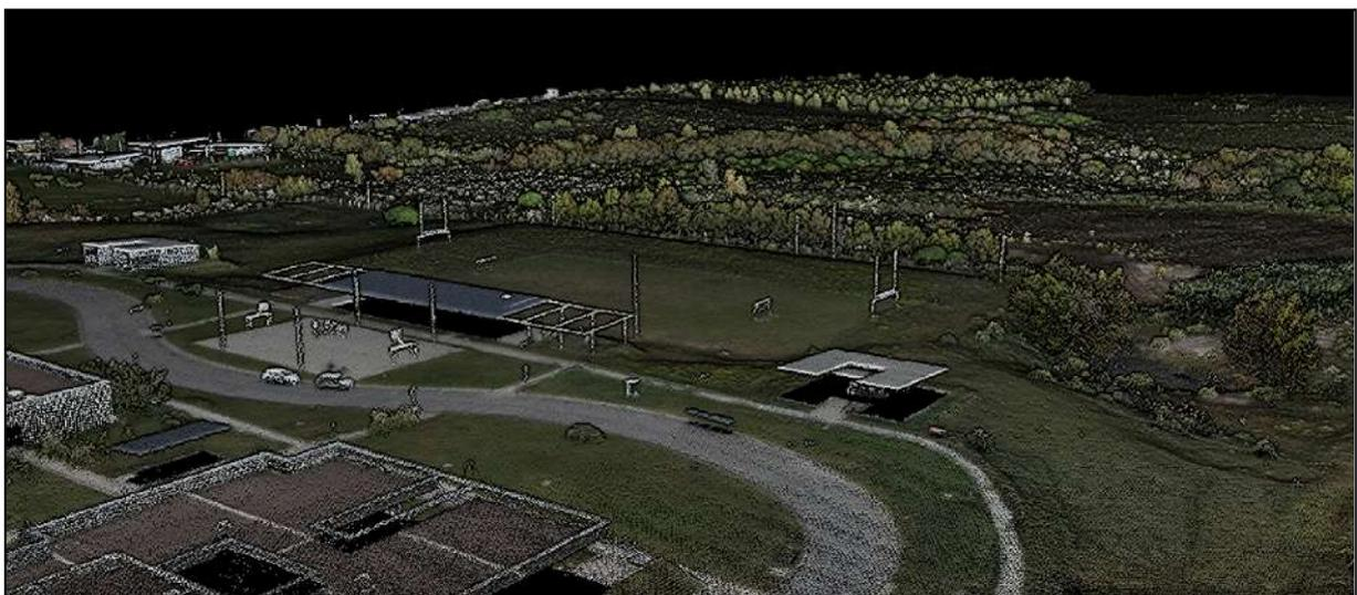
**Imagen 52:** Nube de puntos-Resultado de vuelo de dron. **Fuente:** Creación Propia.
