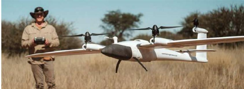
*Imagen 3: Ejemplo de Quantum Systems VTOL Trinity. Fuente: YellowScan. (s.f.). Choosing the perfect drone for LiDAR mapping.*
