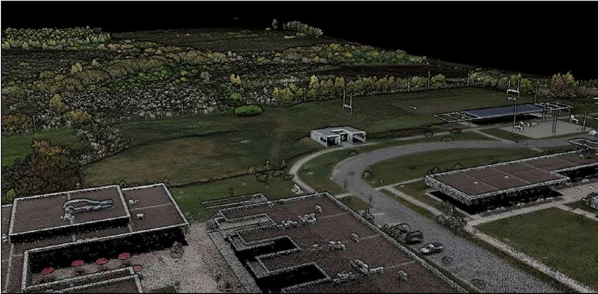
**Imagen 53:** Nube de puntos-Resultado de vuelo de dron. **Fuente:** Creación Propia.
