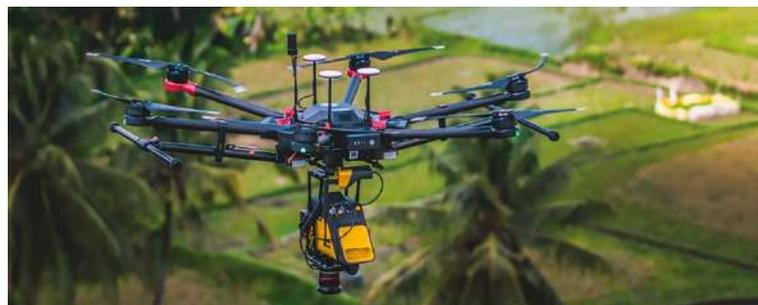
**Imagen 2:** Ejemplo de DJI M600/M300, Videodrone Geodrone X4L. **Fuente:** YellowScan. (s.f.). *Choosing the perfect drone for LiDAR mapping.*
