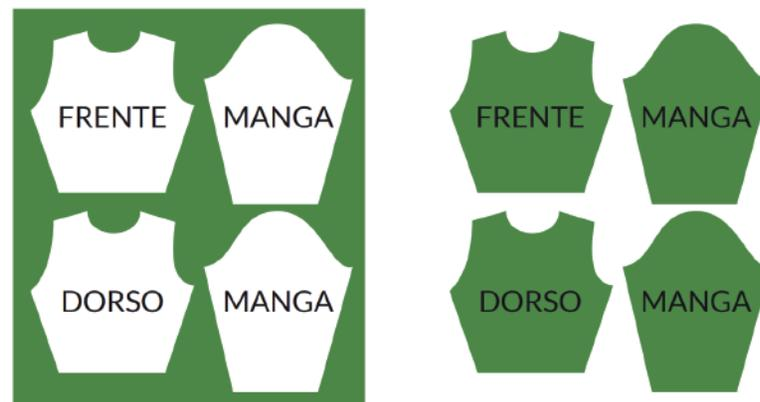
Representación esquemática de dos enfoques productivos en tejido de punto: a la izquierda, confección a partir de una tela tejida de punto sobre la cual se cortan los moldes; a la derecha, confección mediante técnica Fully Fashioned, donde la prenda se teje directamente con la forma del molde, eliminando residuos de corte.
