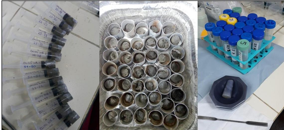
**Figura 4.** Metodología utilizada para la determinación de carbono orgánico. De izquierda a derecha: submuestras del testigo PS3 para determinación de MOT, cápsulas con muestras de sedimento previas a secar, y muestras preparadas para moler en el mortero previo a encapsulamiento.
