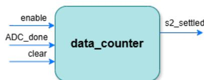
Figura 5.12: Interfaz del bloque *data\_counter*. El mismo cuenta con tres señales de control de entrada. A su salida tiene la señal de control **s2\_settled**, la cual indica que el contador alcanzó el valor objetivo.
