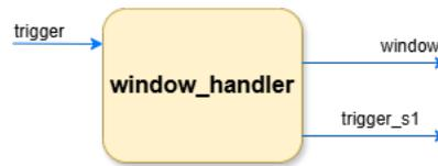
Figura 5.4: Interfaz del bloque *window\_handler*. Cuenta con la entrada **trigger** y las salidas **window** y **trigger\_s1**.
