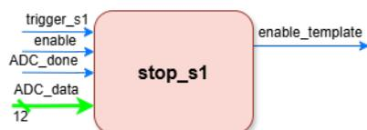
Figura 5.7: Interfaz del bloque *stop\_s1*. Cuenta con las señales de control **trigger\_s1** y **enable** para sincronizar el funcionamiento del bloque y la señal **ADC\_done** para recibir los datos del ADC, a través del bus **ADC\_data**. La salida del bloque es la señal **enable\_template**, la cual indica por nivel alto cuando el error del ciclo está por encima del umbral preestablecido.
