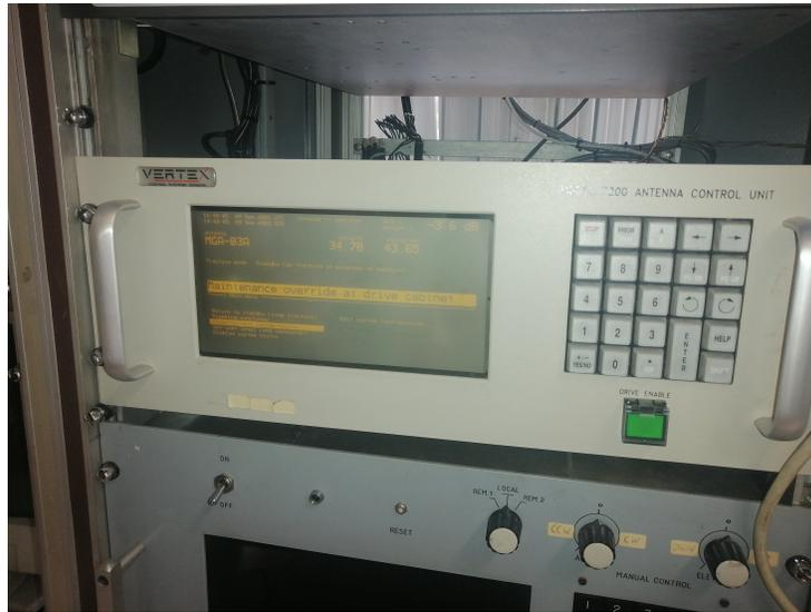
Figura 3.11: Panel de control de la unidad de control de antena (ACU).
