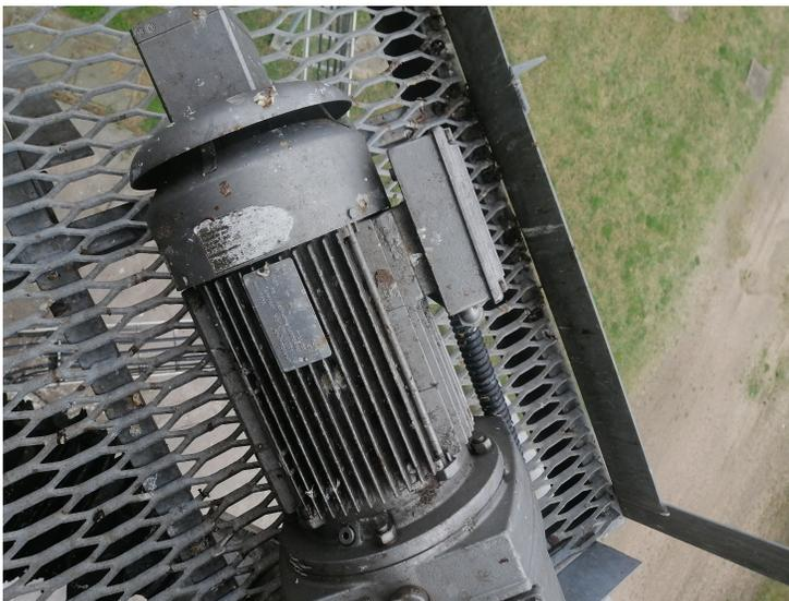
Figura 3.14: Motor de movimiento en elevación.
