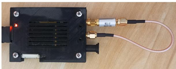
Figura 5.9: Imagen de un Ettus B200 mini. El canal de TX está conectado al RX2 a través de un atenuador de 30 dB, a los efectos de verificar el funcionamiento deseado.
