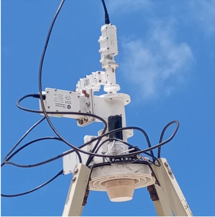
Figura 3.19: Feeder de antena de 4.2m, localizado en el foco del reflector.
