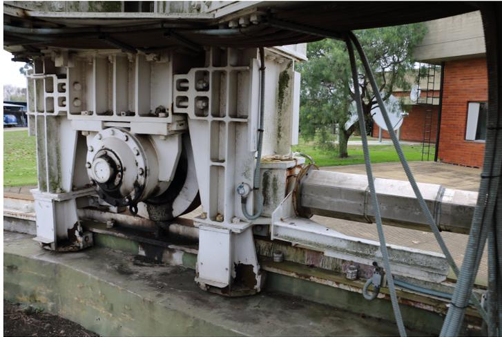
Figura 3.3: Sistema *wheel-and-track* para el movimiento en acimut.
