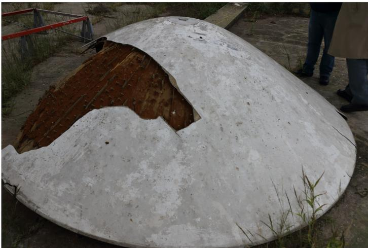
Figura 3.2: Subreflector roto de la antena 2A.
