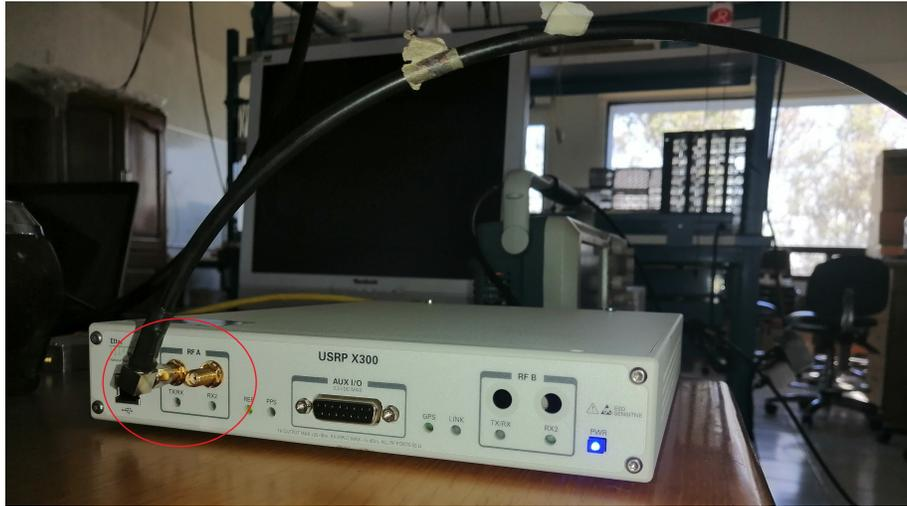
Figura 5.1: Imagen del Ettus USRP X300 utilizado. El círculo rojo marca los canales de entrada del subdevice A.
