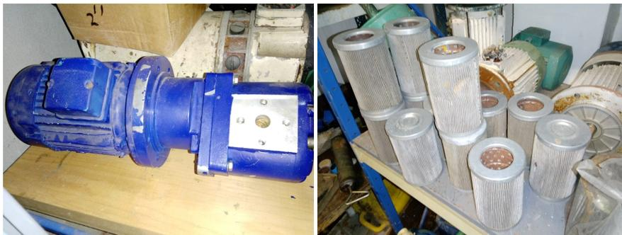
Figura 3.4: Componentes de repuesto disponibles para el sistema de lubricación del tornillo de elevación: bomba de lubricación (izq.) y filtros (der.).
