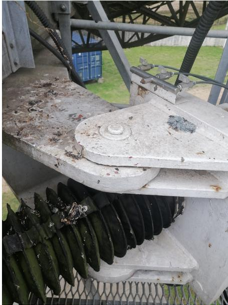
Figura 3.13: Tornillo de movimiento en acimut.
