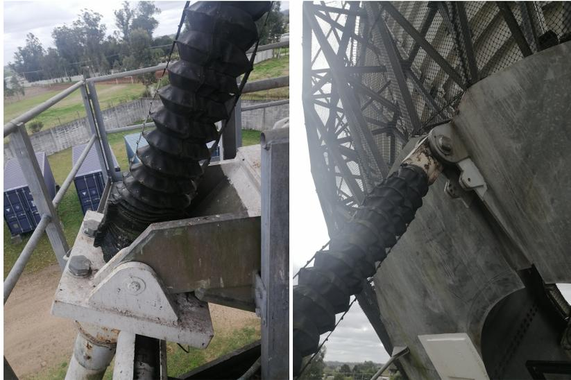
Figura 3.15: Tornillo de movimiento en elevación.
