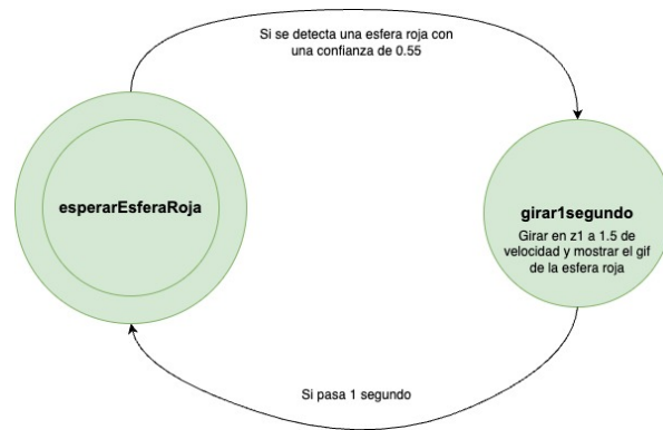
Figura 17: Máquina de estados del comportamiento de ejemplo.
