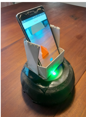
Figura 6: Robotito con el dispositivo móvil incorporado, utilizando como soporte un prototipo de cartón.
