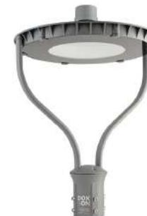
Óptica de policarbonato ABIERTA EXTENSIVA - Color de temperatura: 5000K - CRI>70 - Factor de potencia > 0.95 - Distorsión armónica del driver < 10% - AC 100/250v 50/60Hz - Vida útil: >30.000 hrs - Carcasa de aleación de aluminio de alta eficiencia - IP65 / IK08: alta protección ante golpes - BATERIA DE LITIO INTERCAMBIABLE - Dimensiones: 2600mm diametro - H: 4900mm - Diametro base: Ø75mm - DOXON
