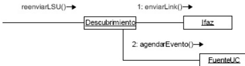
Figura 4.34: Diagrama de colaboración para reenviar paquetes LSU
