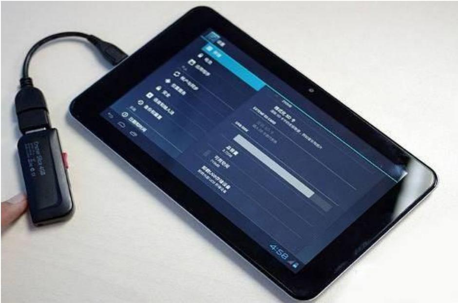
Figura 14: Pendrive conectado a una Tablet mediante un cable USB OTG.
