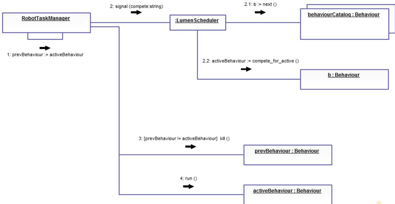
Diagrama de comunicación para el task switching.
