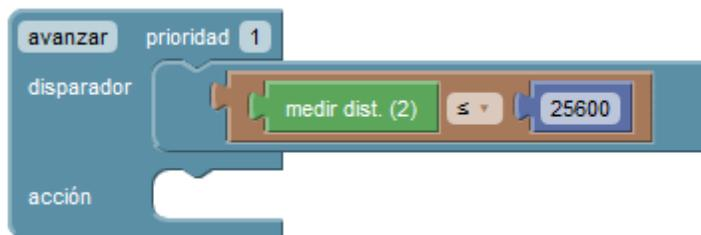
Por último, debemos agregar la acción que realizará el robot cuando se cumpla la condición contenida en el disparador. En este caso, debemos agregar un bloque dentro de la categoría “Butiá” que permita mover al robot hacia adelante.
