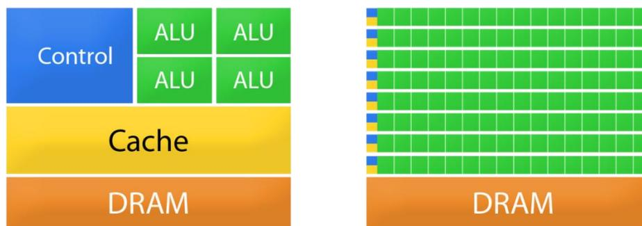
Figura 3.5 – Arquitectura de CPU vs. Arquitectura de GPU. Extraída de [51].
