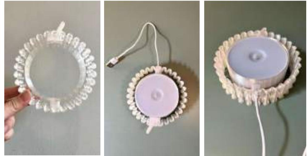
Si bien el interruptor de encendido y apagado impreso se desplazaba correctamente y la ranura para carga USB funcionaba adecuadamente, resultaba demasiado complejo lograr que coincidiera de manera precisa con el botón de encendido del panel.
