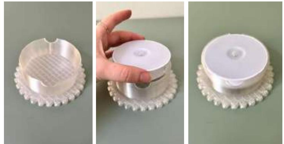
Diseño final de la base con sistema de encastre macho-hembra, sin soportes y optimizado para reducir el consumo de material.
