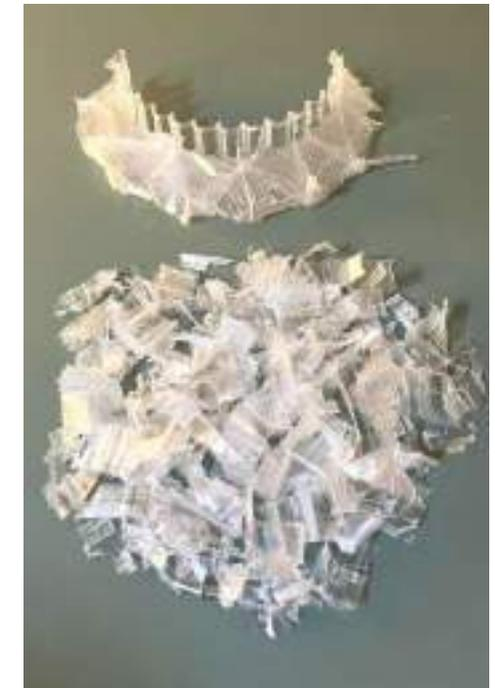
Figura 27. Restos de soportes retirados después de la impresión. *Elaboración propia*
