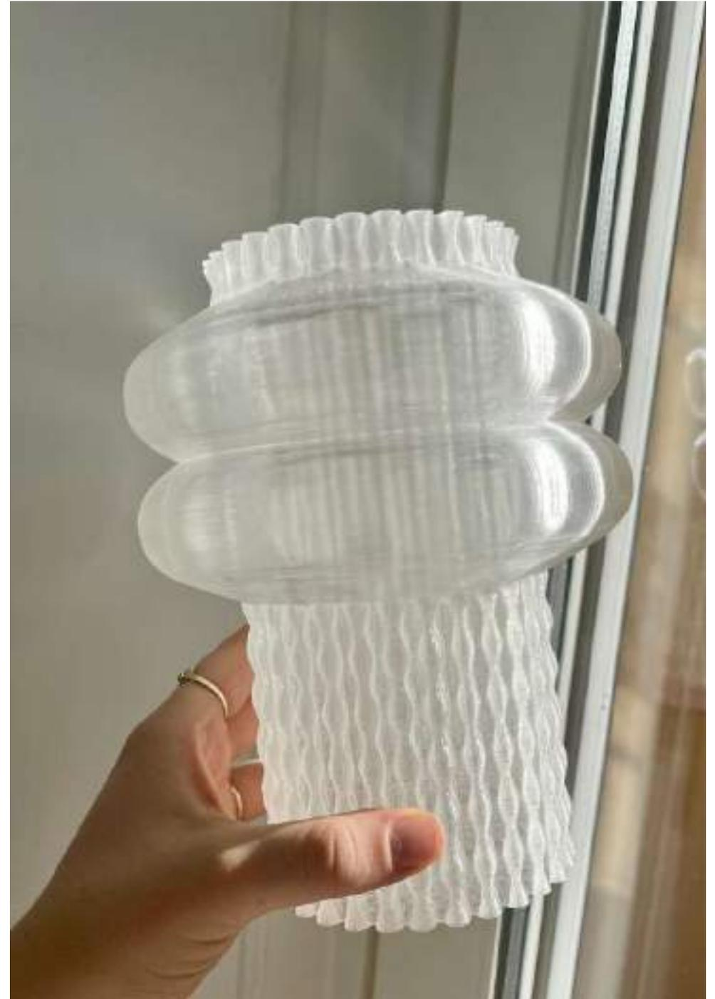
Esta impresión se llevó a cabo utilizando un nozzle de 0,4 mm, lo que resultó en un tiempo de impresión considerablemente largo, alcanzando los 2 días y 12 horas de trabajo continuo. Debido a este extenso tiempo de producción, y con el fin de optimizar el proceso y hacerlo más eficiente, se adquirió un nozzle de 0,8 mm con el que se harán las futuras pruebas. Se cree que esta elección permitirá reducir de manera significativa los tiempos de impresión.
