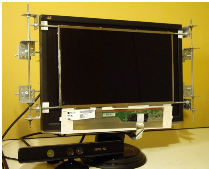
Figura 28. Imagen del prototipo construido, formado por dos pantallas LCD superpuestas y una cámara Kinect.
