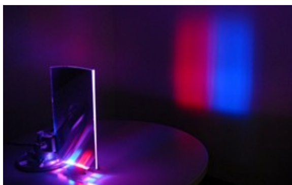
Figura 27. Proyección sobre una pantalla a dos metros de distancia del Wedge. Los LEDs rojos y azules se encuentran separados 30 mm entre sí. [60]
