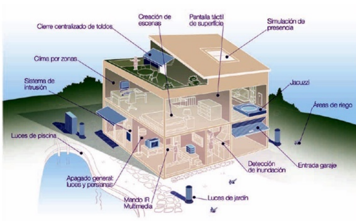
Figura 9: Ejemplo de casa automatizada mostrando las áreas donde se encuentran los sistemas de automatización.
