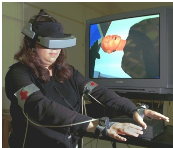
Figura 8: Realidad Virtual para prácticas de reanimación de la cruz roja, utiliza casco estereoscópico, auriculares y sensores para captar los movimientos de las manos
