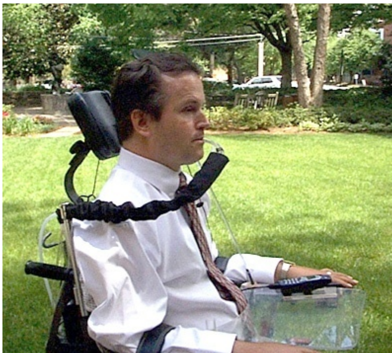
Figura 13: Switch sip-and-puff utilizado para manejar una silla de ruedas eléctrica.
