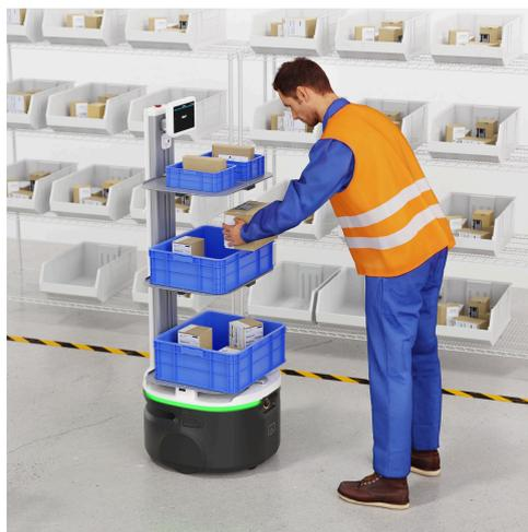
Figura 8: AMR para asistencia en el armado de pedidos. [\[32\]](#)
