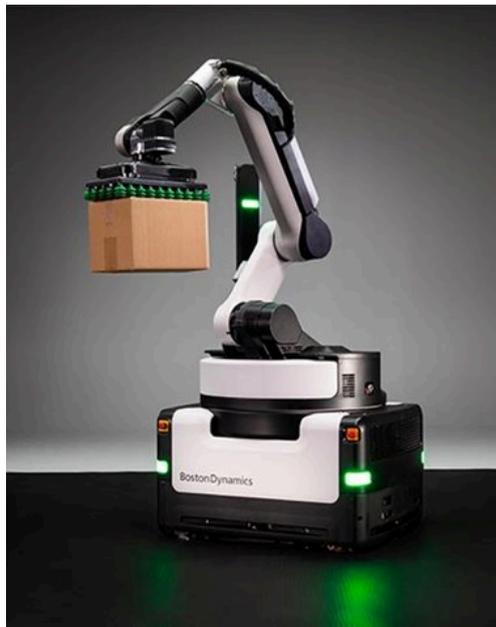
Figura 18: AMR con brazo para pick & place de bultos. [39]
