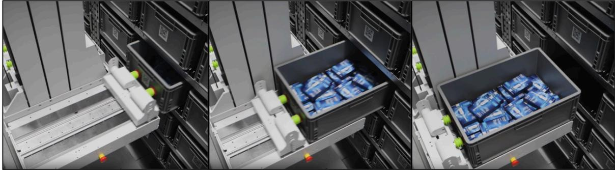
Figura 16: Secuencia de extracción del cajón plástico de la estantería.[\[38\]](#)
