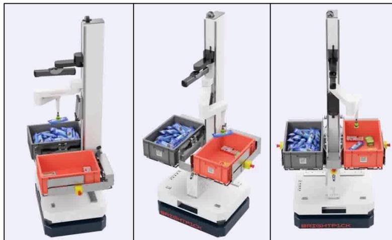
Figura 17: Picking autónomo realizado AMR para “in aisle” picking.[\[36\]](#)
