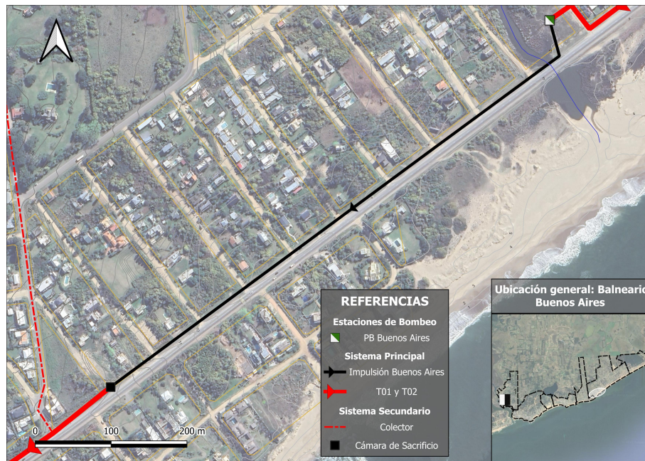
Figura 16: Trazado planimétrico de Impulsión Buenos Aires
