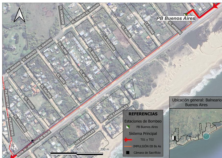
Figura 39: Planimetría de la línea de Impulsión
