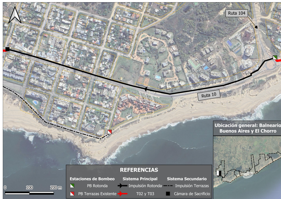
Figura 18: Trazado planimétrico de Impulsión Rotonda
