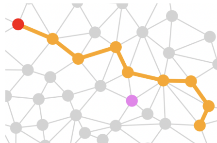
Figura 3.8: El nodo troncal está en rojo, los nodos del recorrido en naranja y el nodo que debe insertarse en el recorrido está en violeta.
