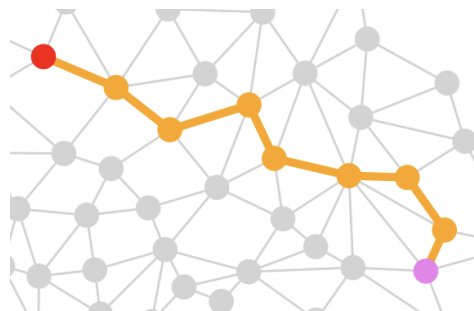
Figura 3.7: El nodo troncal está en rojo, los nodos del recorrido en naranja y el nodo violeta ya fue insertado en la solución.
