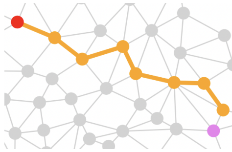
Figura 3.6: El nodo troncal está en rojo, los nodos del recorrido en naranja y el nodo que debe insertarse en el recorrido está en violeta.
