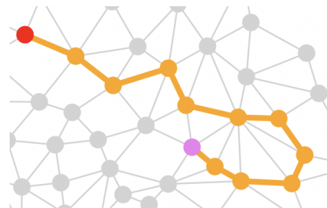
Figura 3.9: El nodo troncal está en rojo, los nodos del recorrido en naranja y el nodo violeta ya fue insertado en la solución.
