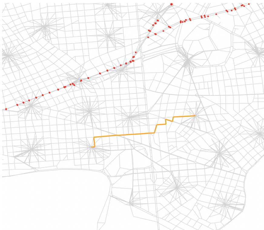
Figura 1.2: Red troncal (en rojo y punteada) y recorrido de segundo nivel no alimentador (en naranja)
