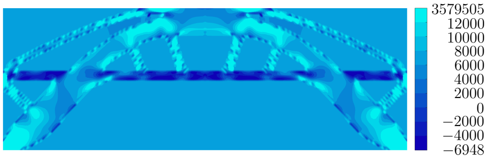
Figura 6.46: DT de la función objetivo del problema del LA en el resultado del caso base del segundo ejemplo
