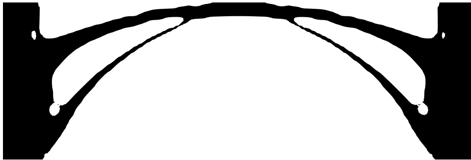
Figura 6.52: Geometría optimizada obtenida para el segundo ejemplo en caso de solamente considerar b y no considerar obligatorio el tablero
