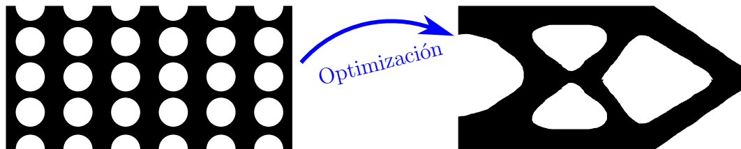
Figura 3.19: Ejemplo de sembrado inicial de huecos para optimización topológica de estructuras
