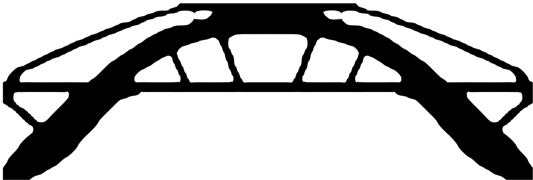
Figura 6.44: Estructura final optimizada del caso base del segundo ejemplo
