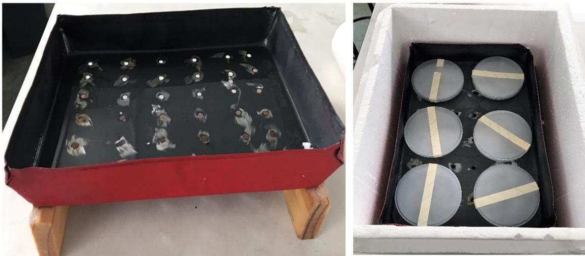
**Fig. 1.1: Dispositivo de congelamiento semicontrolado. El dispositivo consistió en un baño de alcohol isopropílico dentro una caja de poliuretano, en la que se coloca una bandeja de metal sobre la que se sitúan las placas conteniendo la suspensión de colágeno y condroitín-6-sulfato, luego la caja se cierra lo más herméticamente posible y es almacenada en freezer a -80 °C.**
