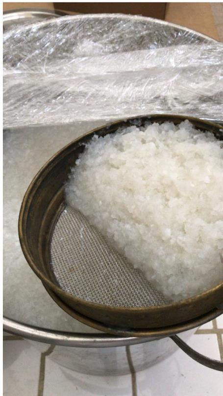
**Fig. 1.5: Extracción del colágeno.** En la imagen se observa la etapa de separación del tendón del resto de la solución acética mediante un tamiz.
