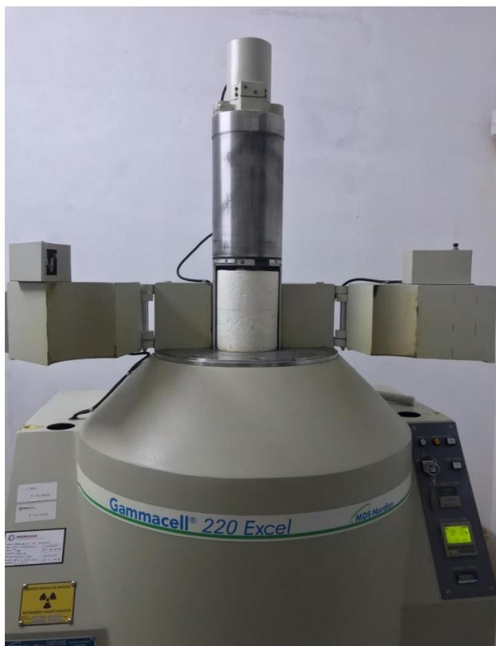
**Fig. 1.7: Equipo Gammacell 220 Excel con el que se llevaba a cabo la irradiación gamma. Para generar entrecruzamiento entre las moléculas, las muestras se irradiaban congeladas.**
