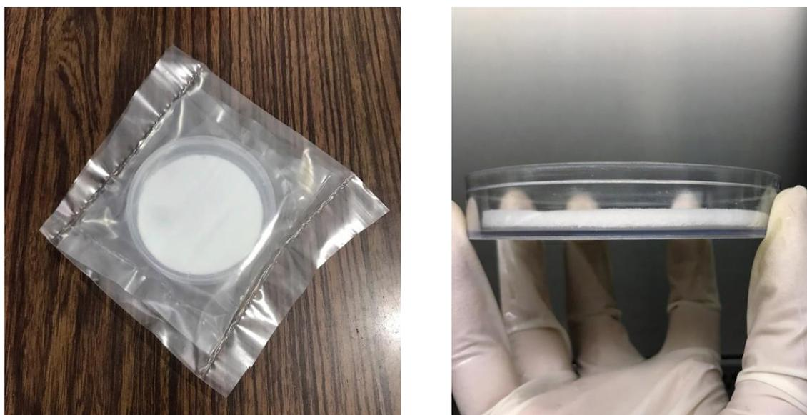
**Fig. 1.9: Bicapa polimérica de colágeno tipo I y condroitín-6-sulfato al final del proceso de síntesis.** Las imágenes muestran la matriz desarrollada en este trabajo previo al momento de empaquetado (derecha), y luego de ser empaquetados y esterilizados con radiación gamma.
