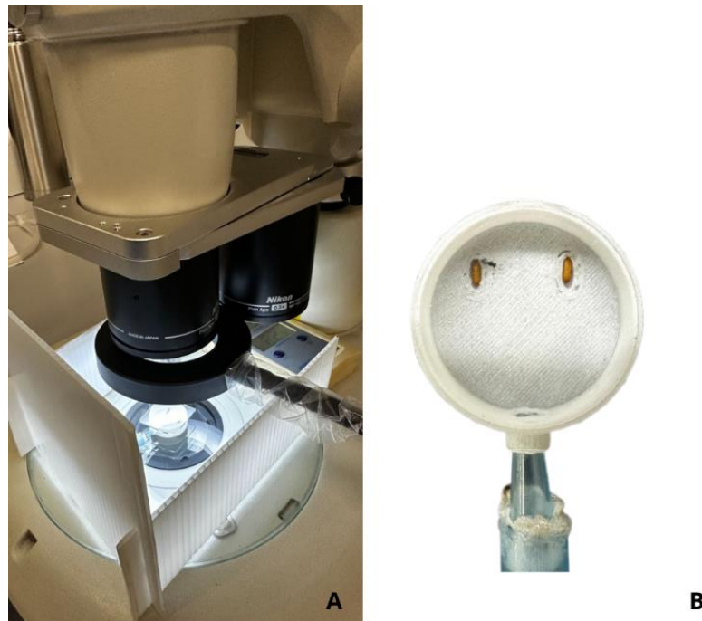
Figura 6. Set experimental para filmación de ensayos de comportamiento A. Microscopio estereoscopio utilizado para filmar los comportamientos. Se puede observar difusor de luz para aislar el sistema de estudio del entorno. B. Arena experimental. En celeste se observa jaula de liberación de los individuos experimentales.
