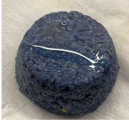
Figura 23: Prueba protección, resistencia al agua. (2023). Fotografía propia.
