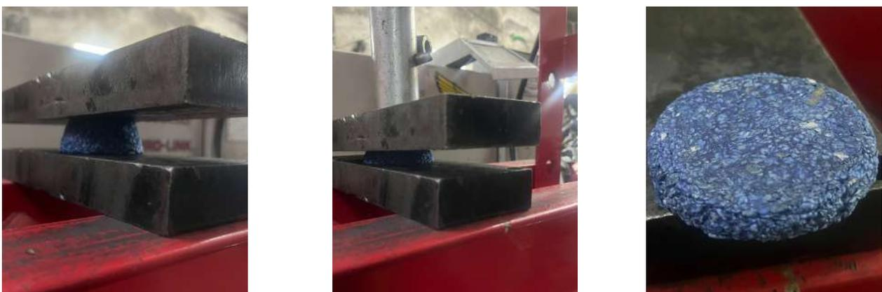
Figura 30: Prueba a esfuerzo de compresión. (2023). Fotografía propia.
