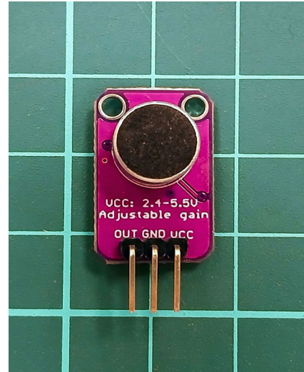
Figuras 40 y 41: Imágenes del proceso de soldado de pines en el sensor MAX4466
