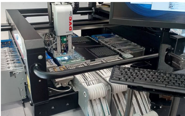
Figura 29: Imagen del equipo "Pick & Place" realizando el proceso de colocación de componentes en una placa.
