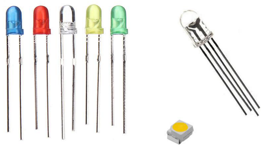
Figura 05: Imagen de referencia de LEDs comunes, LEDs RGB (cuatro patas), y LEDs SMD
