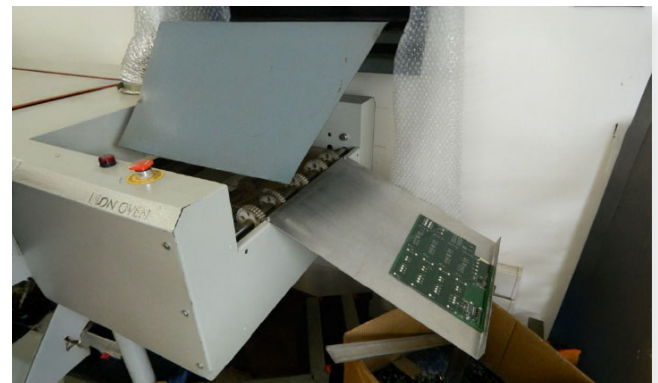
Figura 31: Imagen mostrando una placa salida del horno en cinta
