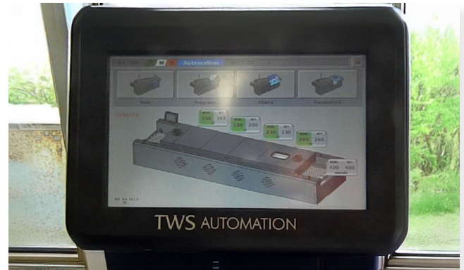
Figura 30: Imagen de interfaz para controlar el horno, mostrando las etapas del horneado
