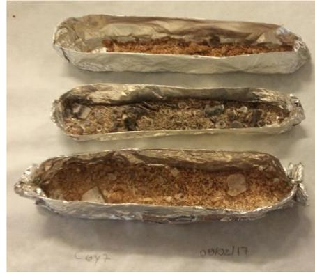
Figura 13 y 14: Muestras de cenizas de compost, obtenidas de horno mufla.
