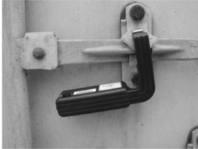
Figura 22 – Sello Inteligente para Contenedor Fuente: RFID Applied
