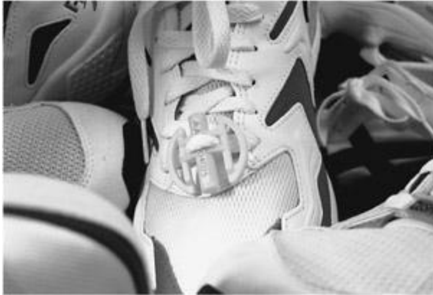
Figura 40 – Chip adherido a Zapatilla de Corredor (centro de la imagen)
