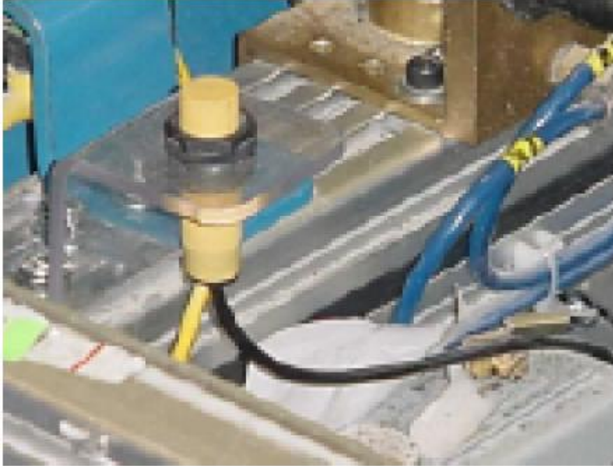
Figura 48: Antena entre los rodillos de la transportadora Fuente: RFID Magazine
