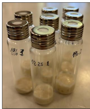
Figura 9 – Viales con masas fermentadas 24hs previo a análisis de compuestos orgánicos volátiles por GC/MS
