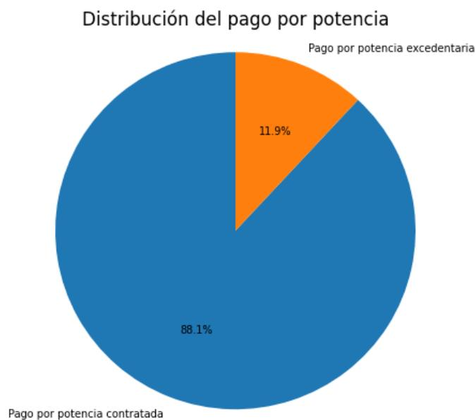
Figura 5.18: Distribución del pago por concepto de potencia con el BESS activo.
