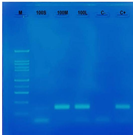
**Figura 12.** Fotografía del gel de electroforesis mostrando las bandas obtenidas de los tres tipos de tejidos del animal 100, (M: marcador de peso molecular). C- (control negativo) y C+ (control positivo)
